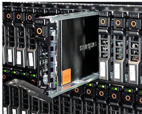
Samsung SSD 830が搭載されたサーバの写真
