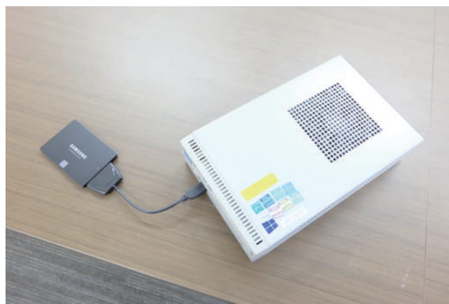
USB 3.0接続ポータブルSSDキットで接続し、「Data Migration」でデータをコピー
