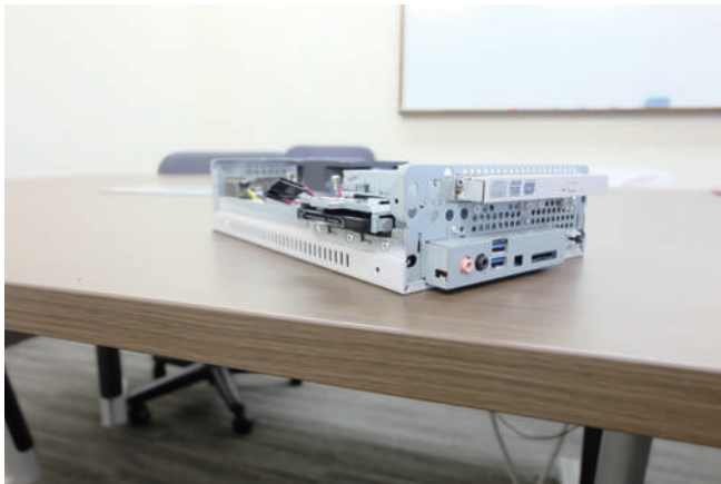
HDDが入っていたスペースに「860 EVO」を挿入
