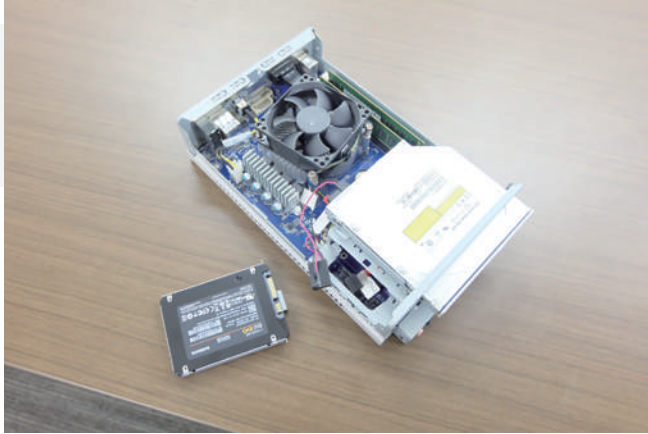
パソコンのカバーを開けて内蔵のHDDを取り外す
